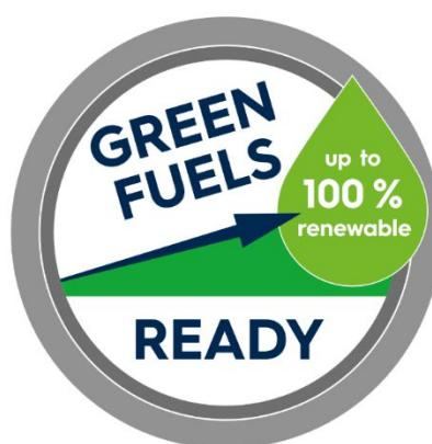
Das Green-Fuels-Ready-Produktlabel verdeutlicht die Praxistauglichkeit gekennzeichneter Geräte für den Einsatz bis zu 100 Vol-% erneuerbarer flüssiger Brennstoffe (z.B. HVO, XtL, FAME), auch in Mischungen mit mineralölstämmigen flüssigen Brennstoffen.
