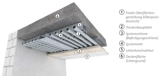
Abbildung 9: Deckenaufbau „Schienensystem-Trockenbauweise“; Quelle: BDH
