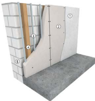
Abbildung 5: Wandaufbau Modulbauweise; Quelle: BDH
