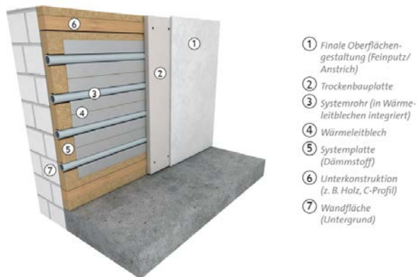
Abbildung 7: Wandaufbau Registerbauweise; Quelle: BDH
