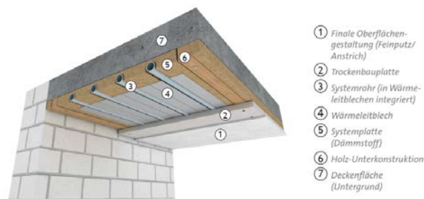
Abbildung 8: Deckenaufbau Registerbauweise; Quelle: BDH
