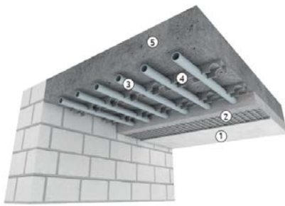
Abbildung 4: Deckenaufbau Schienensystem; Quelle: BDH
