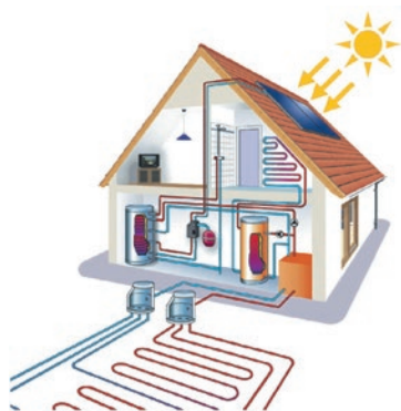
Bild 4: Wärmepumpenheizung mit Erdwärmekollektor
