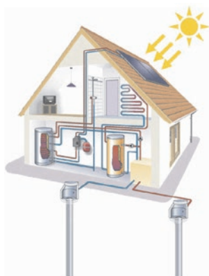
Bild 6: Wärmepumpenheizung mit Grundwassernutzung
