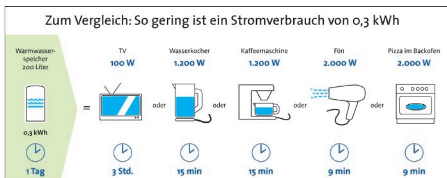
Abb. 7 Vergleich der benötigten Strommenge zur Abdeckung der Warmhalteverluste eines Warmwasserspeichers mit typischen Verbrauchswerten ausgewählter Haushaltsgeräte
